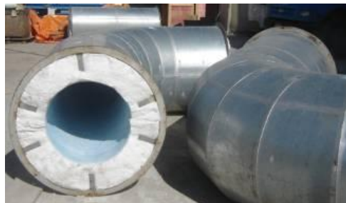
Isolamento interno de tubulação protegido com Enrijeecedor.
